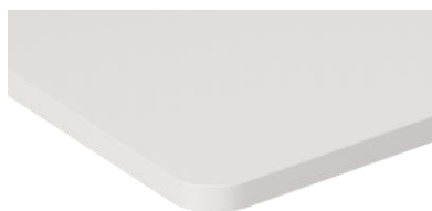
PIANO NOBILITATO SPESSORE 25mm Con angoli raggati 40mm
